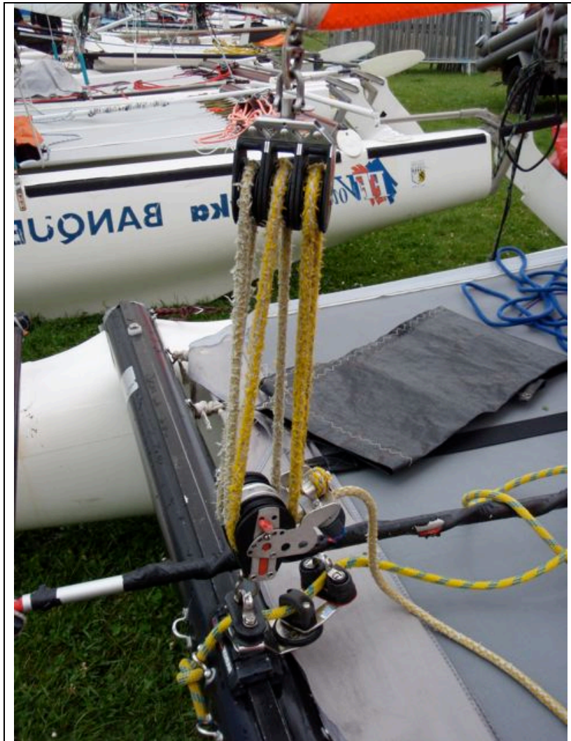
Détail du palan de GV
